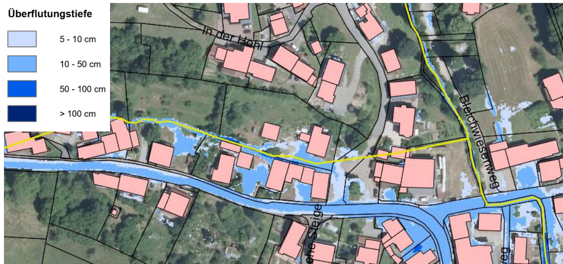
Abb. 5: seltenes Abflussereignis - Auszug Kommunales Starkregenrisikomanagement Stadt Mosbach (Quelle: Stadt Mosbach / Ingenieurbüro Winkler und Partner GmbH)
